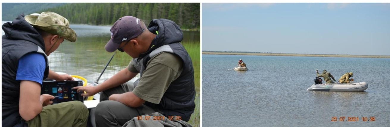
Рисунок 3 – Процесс промеров глубин с применением эхолота и ГНСС оборудования
