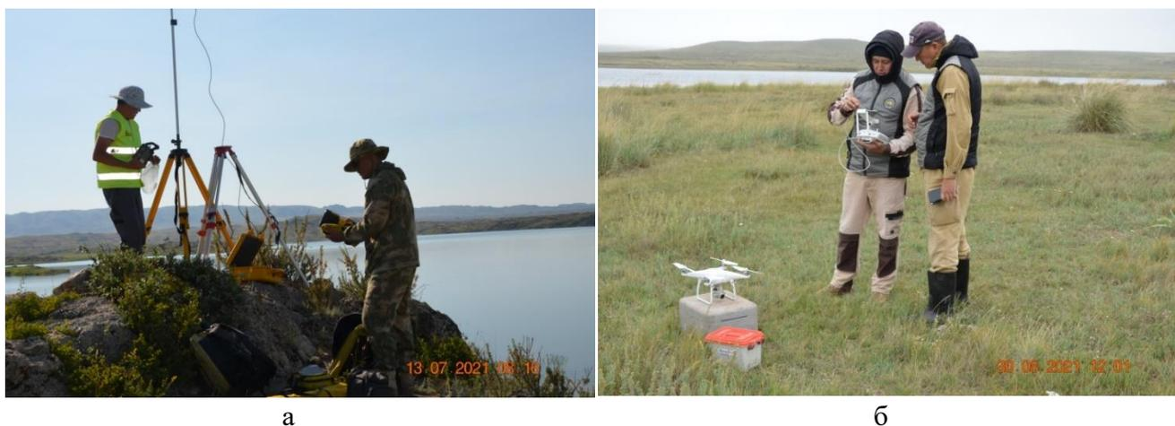
Рисунок 1 – Базовая станция ГНСС (а) и аэрофотосъемка с применением квадрокоптера DJI Phantom 4 pro (б)
