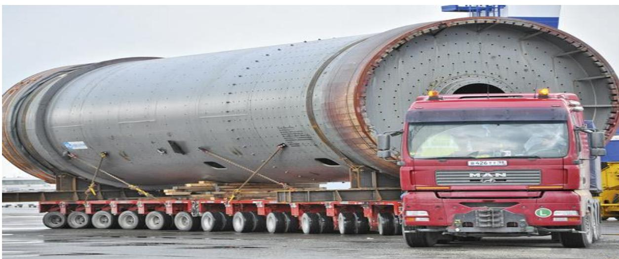
Рисунок 1 - Многоосные полуприцепы для перевозки тяжеловесных крупногабаритных грузов.
